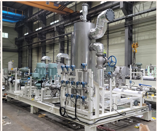
LNG Glycol Water Skid
