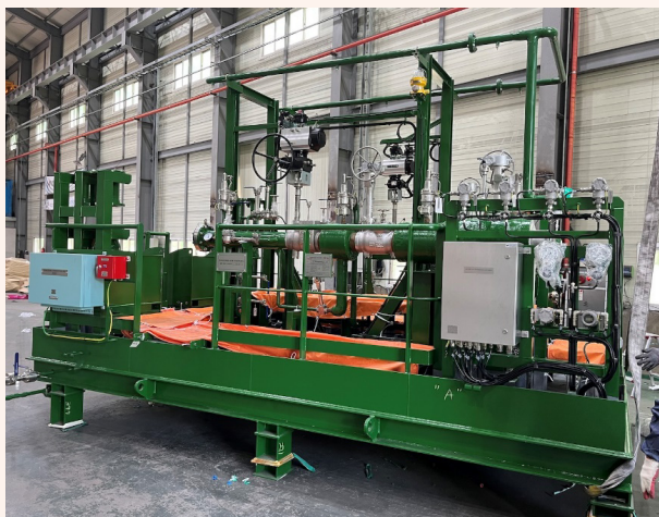
LNG Low Pressure Vaporizer Skid
