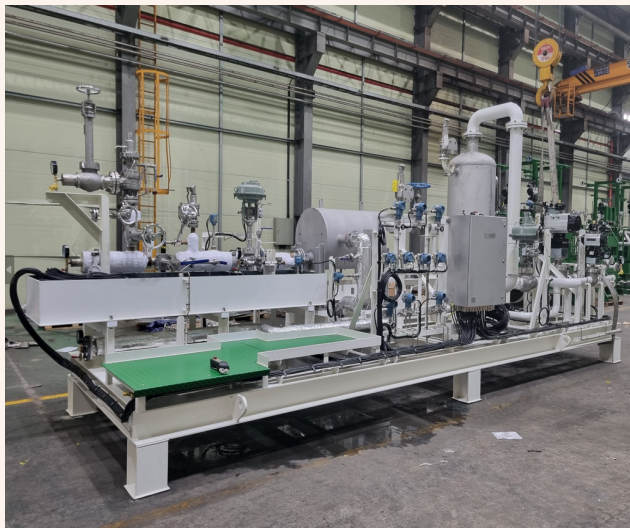
LNG Low Pressure Vaporizer Skid
